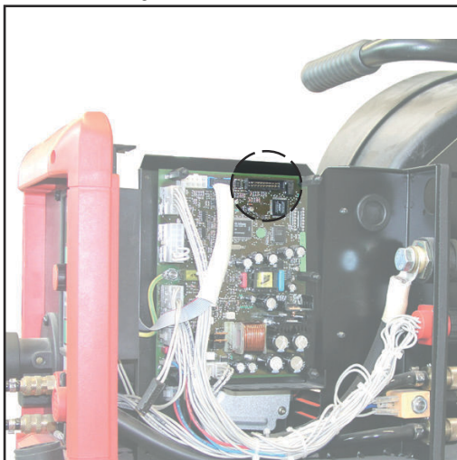
Raccordement du BSL-Tool au circuit imprimé SRXX (régulateur du moteur) - VR 4000, VR 7000
